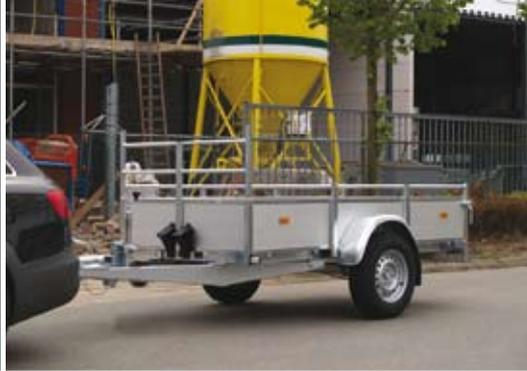
Rahmen: komplett geschweißt und vollbad feuerverzinkt, gebremste Ausführungen mit geschraubter V-Deichsel ▼
